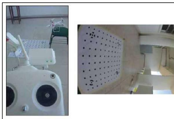
Fig. 2 – Calibração da câmera. Fonte: Autoria própria (2018).
