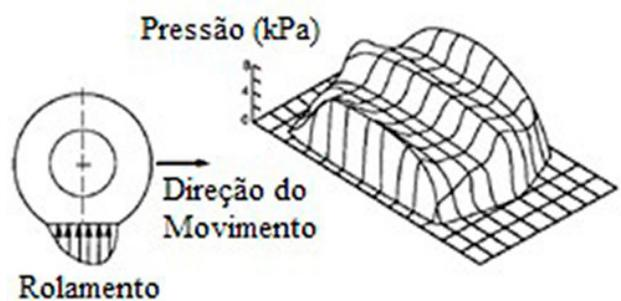
Fig. 9 – Distribuição de pressão no pneu [10].
