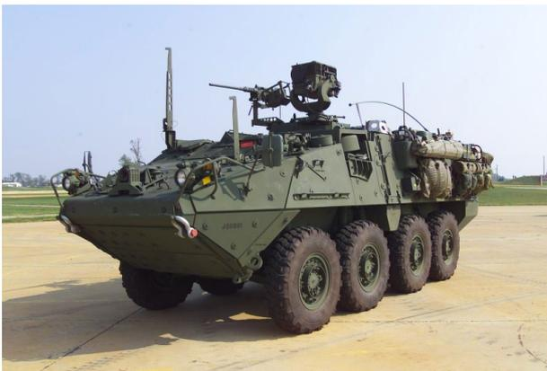
Fig4- M1127 Recon Vehicle Stryker. Fonte: Army Recognition, EUA.
