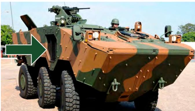
**Figura 07:** Sistema de arrefecimento (conjunto de radiadores) voltado para a lateral do carro
