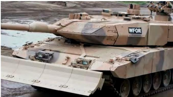
**Figura 02:** Modelo de uma Lâmina *Bulldozer* instalada em um carro de combate
